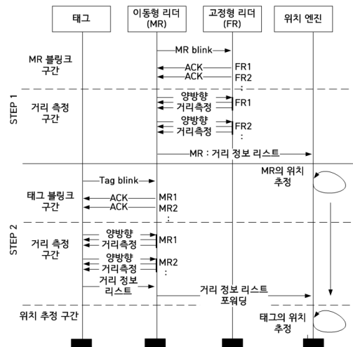
그림 7. 고정형 리더와 이동형 리더를 이용한 2단계 위치 추정 기법 프로토콜
