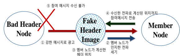
그림 4. 강한 에너지 전송 행위 탐지 방법 Fig. 4. Strong signal misbehavior detection method
