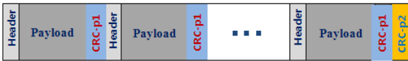
그림 2. CRC-p 코드를 사용한 전송 데이터 패킷의 블록도 Fig. 2. A block diagram of transmit data packet with CRC-p code
