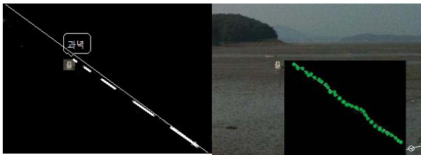
그림 10. 탄환이 목표를 맞추지 못한 경우의 선형회귀선(좌)과 재귀적 방법으로 찾은 추적선. Fig. 10. A linear regression and recursive regression when target is no hit.
