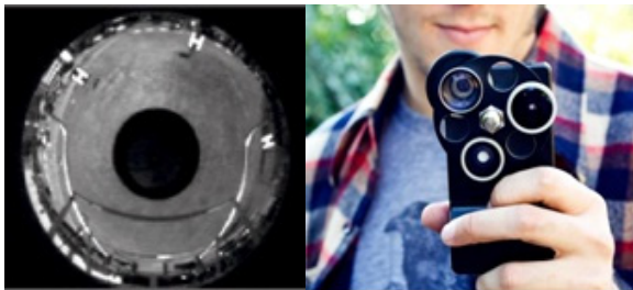
그림 1. 헬기에서 촬영한 어안렌즈 영상과 어안렌즈를 사용한 스마트폰 장착 카메라 기기 Fig. 1. An image from a helicopter by fish-eye lens and a device equipped smart phone with fish-eye lens
