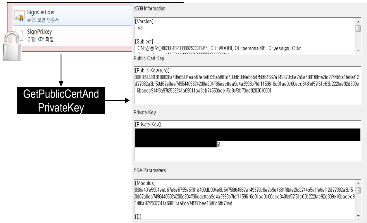
그림 6. 암호화된 패키지로부터 공인인증서와 개인키를 꺼낸 모습 (A社) Fig. 6. Extracting a public key and a private key from the encrypted packet (A-company)
