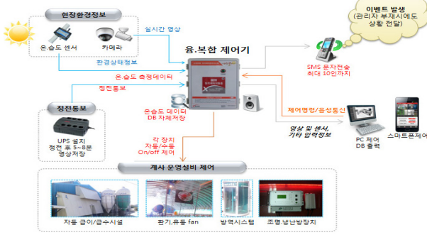
그림 3. 지능형 축사 원격관리 시스템 [15] Fig. 3. Intelligent livestock farm remote management system [15]
