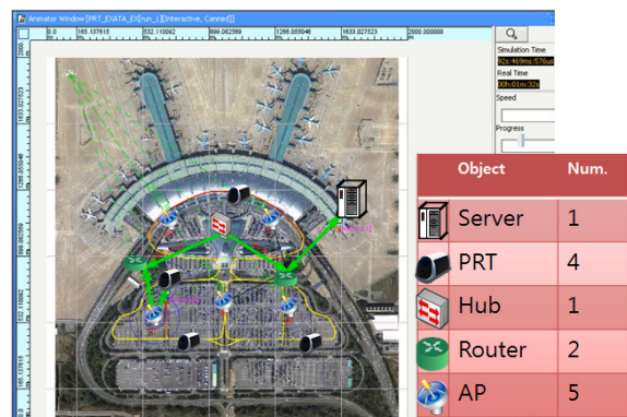
그림 4. PRT 차량, 통신설비 및 통신환경 설정에 따른 실시간 네트워크 시뮬레이션 환경 Fig. 4. Realtime network simulation environment composed of configured protocol stack, communication infrastructure and PRT vehicles
