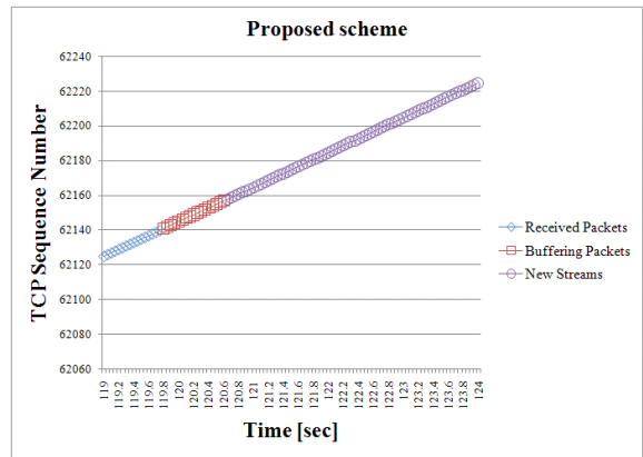
그림 13. 제안 방안의 TCP 순서 번호 Fig. 13. TCP Sequence Number of Proposed Scheme
