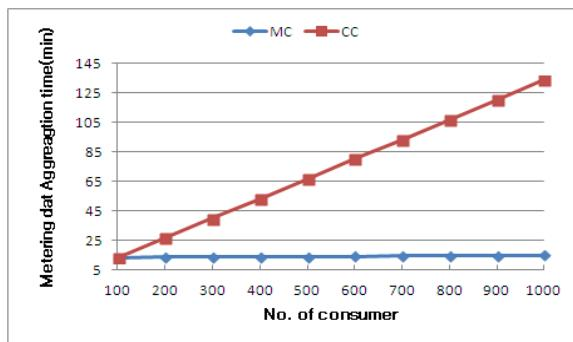
그림 10. 검침데이터 수집 시간(MC Vs CC)
