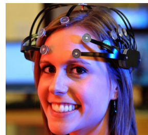
그림 2. 건식 전극을 탑재한 뇌파 측정용 헤드셋 착용 모습 Fig. 2. Headset with dry-type electrode
