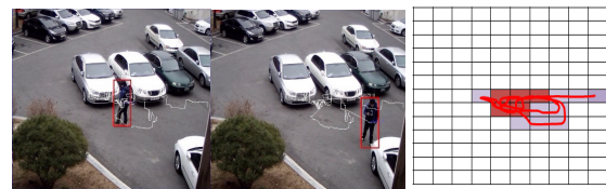
(a) 객체 검출 (b) 객체의 궤적 (a) Object detection (b) Trajectory of object 그림 6. 배회 검출 결과 Fig. 6. Loitering detection result
