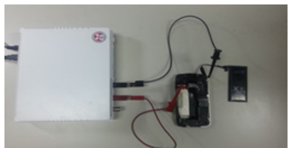
그림 6. iPhone4의 소비 에너지 측정을 위한 monsoon power monitor Fig. 6. The monsoon power monitor for measuring the consumed energy of iPhone4
