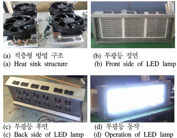
그림 9. 고출력 LED 투광등 구현 사진
