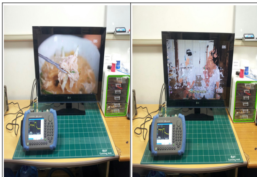
그림 5. TVBD 송신전력에 따른 DTV 수신상태 검증 Fig. 5. DTV reception status verification in accordance with the TVBD transmit power
