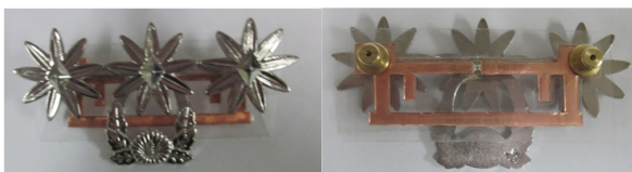
그림 2. 제작된 대령계급장 UHF RFID Tag 안테나. Fig. 2. Fabricated Colonel insignia UHF RFID tag
