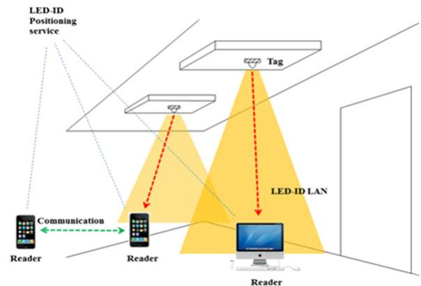
그림 1. LED-ID 시스템 모델.
