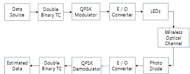
그림 2. 제안한 LED-ID 통신 시스템 블록 모델.
