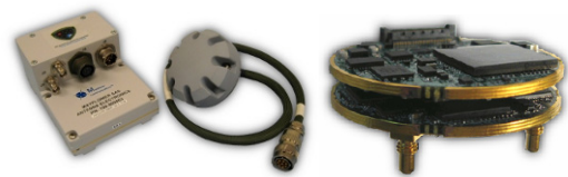
(a) SAS 항재밍 모듈 (b) NavGuard100 모듈 (a) SAS Anti-Jam module (b) NavGuard100 module 그림 10. Mayflower 사의 SAS 및 NavGuard100 Fig. 10. SAS and NavGuard100 by Mayflower
