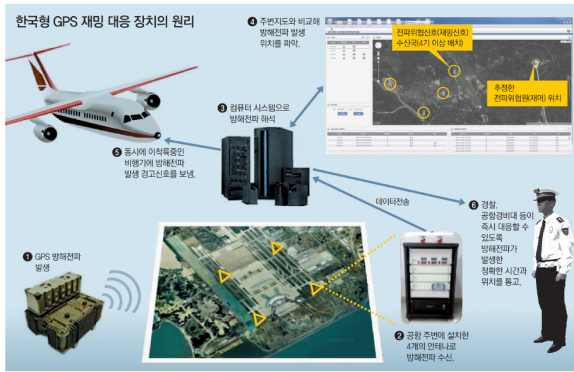
그림 6. 항공우주연구원의 전파위협원 위치추적시스템 Fig. 6. Jamming position tracking system of KARI
