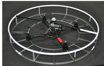
그림 7. 원형 링 반사패턴이 설치된 쿼드콥터 비행체 Fig. 7. The target quadrotor on which a reflective circular ring pattern is installed
