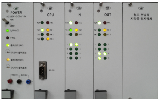
그림 21. 센서 2 기준점 이탈 시 제어부 작동 상태 Fig. 21. Operation state of control part in case of breakaway base pointer of sensor 2
