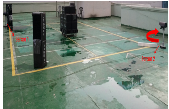
그림 22. 센서 1 고장 및 센서 2 기준점 이탈 시물레이션 Fig. 22. Simulation for Failure of sensor 1 & Breakaway base pointer of sensor 2
