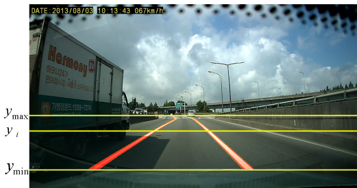
그림 8. 영상의 붉은 실선으로 표시된 차선의 실제 값 Fig. 8. Red marks represent the ground-truth of the lanes
