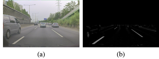
그림 6. (a) 입력영상 I(x,y) (b) lane marker detector 통과 후의 결과영상 I_L(x,y) Fig. 6. Lane marker detection: (a) an input image, I(x,y) (b) the result image, I_L(x,y)
