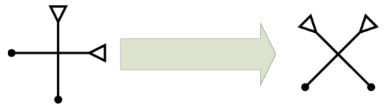
그림 2. 교차 이중 편파 안테나 시스템 Fig. 2. Cross dual-polarized antenna system
