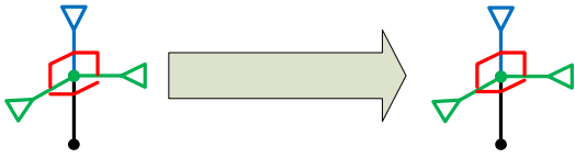
그림 18. 선택적 이중 편파 안테나 시스템 Fig. 18. Selective dual-polarized antenna 시스템
