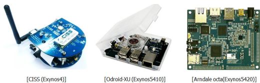
그림 5. 영상 분석 성능 평가를 위한 테스트 보드 Fig. 5. Test boards to evaluate video processing performance
