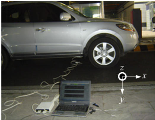
그림 4. 주행차로에서 SUV 차량의 자기장 측정 Fig. 4. Magnetic Field Measurement for SUV in Road Lane.
