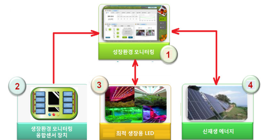
그림 1. 요소기술들의 시스템 통합화 구성도 Fig. 1. Integrated System Layout of elementary technologies.
