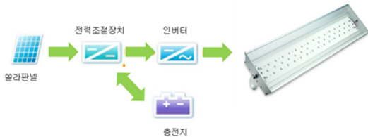
그림 11. 독립형 태양광발전 시스템. Fig. 11. the solar energy system of stand-alone type.
