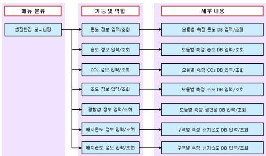
그림 2. 주요 센서의 분류. Fig. 2. the classification of sensors for monitoring system.
