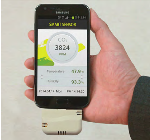
그림 11. 스마트 폰의 화면에 표시된 CO 2 농도 Fig. 11. CO 2 gas concentration displayed on the smart phone display
