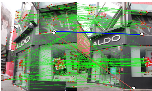
그림 4. SIFT 기법을 이용한 특징점 정합 Fig. 4. Feature point matching by the SIFT algorithm
