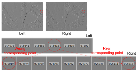
그림 5. 기울기 영상의 잘못된 대응점 탐색 Fig. 5. Matching ambiguity problem in gradient images
