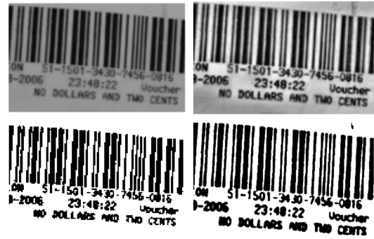
그림 2. 부화소 동기화 적용 예 (좌상: 발췌 원본, 좌하: 이진화결과, 우상: 업샘플링 결과 우하: 업샘플링 후 이진화) Fig. 2. An example of upsampling-subpixels synchronization (top-left: original, top-right: upsampled(x5), bottom-left: binarized low resolution, bottom-right: binarized after upsampled)
