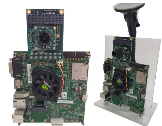
그림 3. 다중 노출 스마트 차량용 카메라 프로토타입 Fig. 3. Prototype of multi exposure smart vehicular camera
