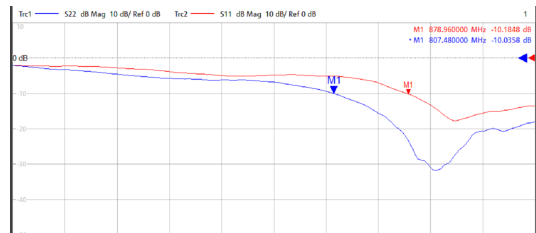
그림 23. (b) 두 안테나의 확대된 반사손실 Fig. 23. (b) Enlarged return loss of the two antenna
