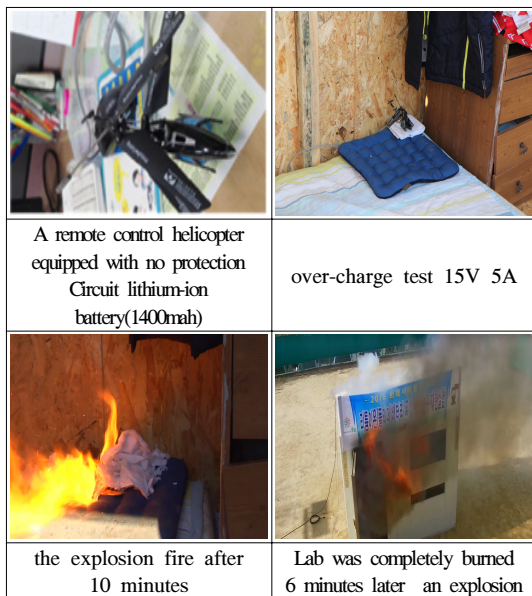
그림 2. RC무선헬기 리튬이온 배터리 폭발 재현실험 Fig. 2. Remote controller helicopter Lithium-ion battery explosion Reproducible experiment
