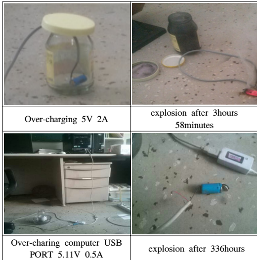
그림 3. 전자 담배 리튬 이온 전지 폭발 재현성 실험 및 리튬 이온 전지 안전성 검증 실험 Fig. 3. E-cigarettes Lithium-ion battery explosion reproducible experiment and Li-ion battery safety verification experiment
