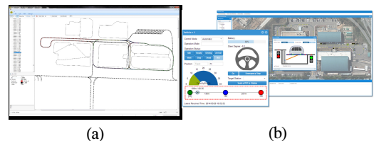
그림 12. 미니트램 운행제어시스템의 GUI 화면 (a) 전체노선화면 모니터링 (b) 객체 모니터링 Fig. 12. GUI of mini-tram operation system (a) top view monitoring (b) object monitoring
