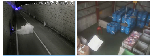
(a) 배경의 낮은 색상 대비와 (b) 연기와 유사한 이동 물체 경계 정보 부족 (a) low background contrast (b) similar moving object and poor with smoke edge information
