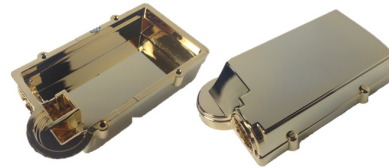
그림 7. 제작된 가스 센서 모듈의 사진 Fig. 7. Photograph of the fabricated gas sensor module
