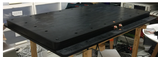
그림 4. 트랜스폰더 리더 안테나 (2차 시작품) Fig. 4. Transponder reader antenna (prototype II)
