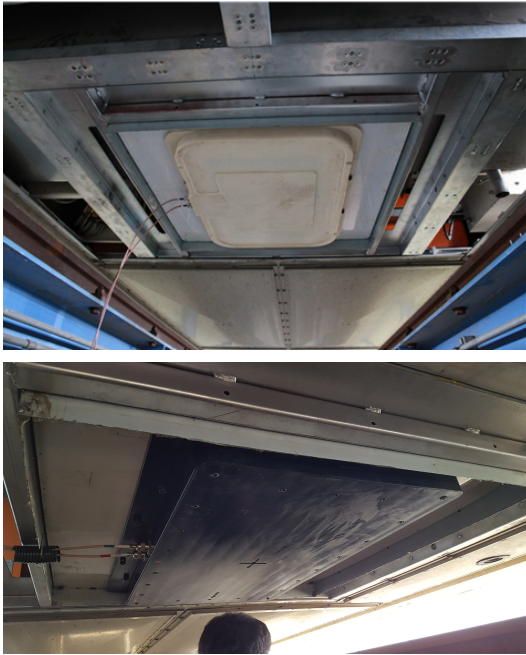
그림 5. HEMU-430X M2 차량 하부에 설치된 트랜스폰더 리더 안테나 (위) 1차 시작품 (아래) 2차 시작품 Fig. 5. Transponder reader antenna mounted beneath HEMU-430X M2 (top) prototype I (bottom) prototype II
