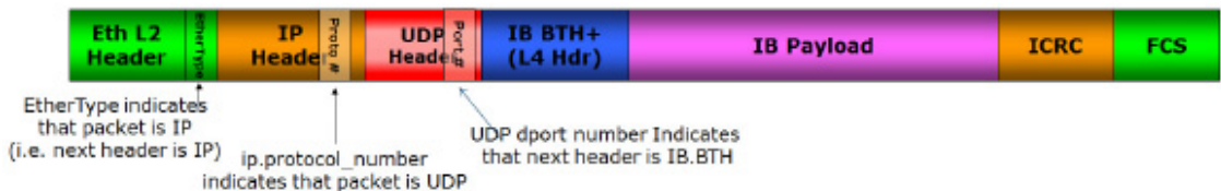
그림 5. RoCEv2 패킷 포맷 Fig. 5. RoCEv2 Packet Format
