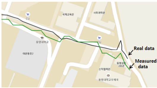
그림 16. 기준위치와의 위치 편차 시험 결과 Fig. 16. Test results of the location difference for reference location
