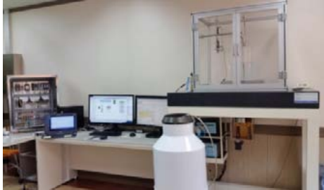
그림 8. 무게식 강수량계 성능시험 Fig. 8. Performance test of weighted precipitation
