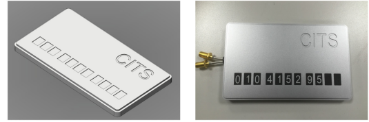
그림 13. 제안한 차량 내부용 원형편파 마이크로스트립 패치 배열안테나 케이스 디자인 Fig. 13. Radome design of the proposed inner antenna
