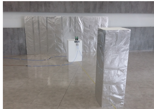
그림 4. 대칭 간접경로 세기 측정 실험. Fig. 4. Experimental setup for generation of symmetric indirect paths.
