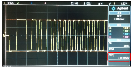
그림 12. 테스트 베드의 RT 스테이더스 워드 출력 레벨 측정 결과 Fig. 12. RT status word output level measurement result of test bed
