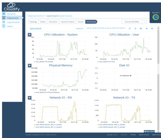
그림 16. CPU 및 네트워크 성능에 대한 실시간 모니터링 Fig. 16. Real-time monitoring of CPU and network performance
