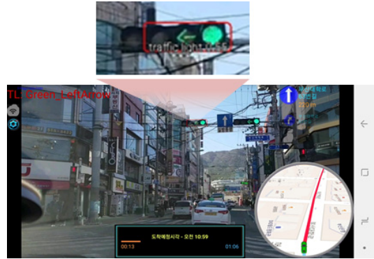
그림 3. 크라우드소싱 내비게이션 앱에서 신호등 영역 추정 Fig. 3. Traffic signal area estimation in crowdsourcing navigation app
