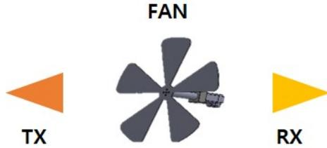
그림 7. 5G K-Test Bench를 위한 밀리미터 웨이브 페이더
