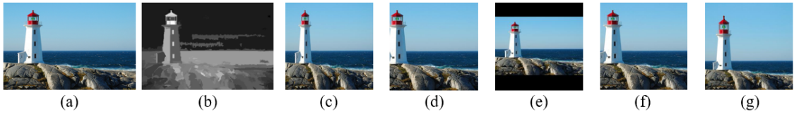
그림 1. 영상 리사이징의 예. (a) 원본 영상, (b) 영상 중요도 지도, (c) 스케일링, (d) 중앙 잘라내기, (e) 레터박스, (f) 내용 기반 잘라내기, (g) 내용 기반 영상 왜곡[5]. Fig. 1. Examples of image resizing. (a) Original image, (b) image importance map, (c) uniform scaling, (d) center cropping, (e) letterboxing, (f) content-based cropping, (g) content-based image warping[5].
