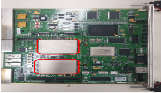
그림 7. 구현된 대역확산 수신기 H/W 플랫폼 Fig. 7. Implemented spread-spectrum receiver H / W platform
