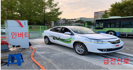
그림 7. 시험에 사용된 인버터와 급전선로 및 전기 자동차 Fig. 7. Inverter, power line and electric vehicle for test
