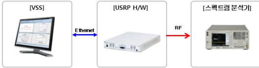
그림 16. WCDMA 하향링크 구현환경 Fig. 16. WCDMA Downlink implementation setup
