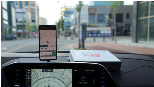
그림 5. 5G-V2X 실증을 위한 단말 구성: 5G 스마트폰(좌)과 C-V2X OBU (우)를 연동하여 차량간 안전 메시지와 영상 전달 Fig. 5. 5G-V2X test device: 5G smart phone (left side) and C-V2X OBU (right side)
