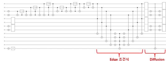
그림 11. Quirk 시뮬레이터를 이용한 전체 양자 회로도
