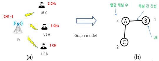
그림 3. Channel Allocation을 위한 색칠 문제 Fig. 3. Coloring Problem for Channel Allocation
